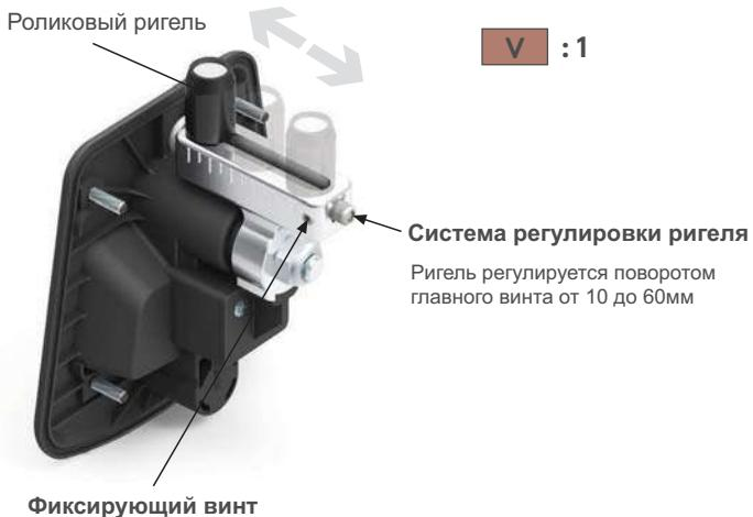
Чтобы отрегулировать ригель, сначала ослабьте фиксирующий винт.
